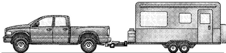
FIG. 2. WITH WEIGHT DISTRIBUTION (CORRECT)
